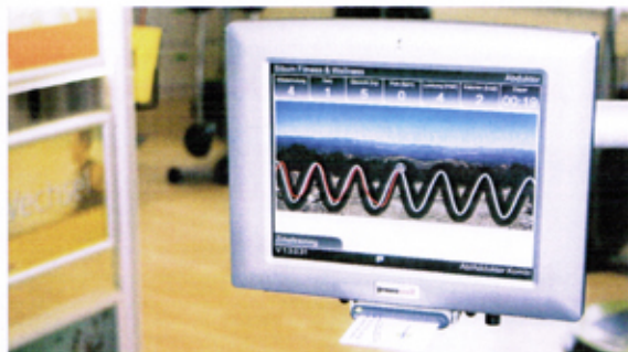
Die konzentrische und exzentrische Arbeit einer Muskelpartie wird als farbige Sinuskurve auf dem Bildschirm sichtbar.
