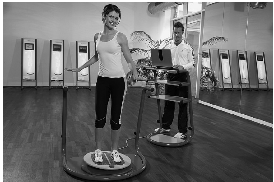
Abb. 1 Gut koordinierte Ausgleichsbewegungen sorgen dafür, das Gleichgewicht auf der kippeligen Scheibe zu halten. Die Bewegungen werden durch Neigungs- und Beschleunigungssensoren erfasst.
